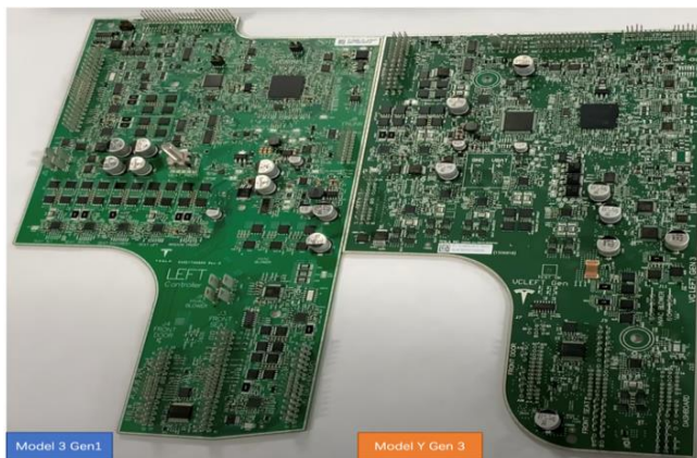
图 16：model Y 控制器元件间距明显更小
