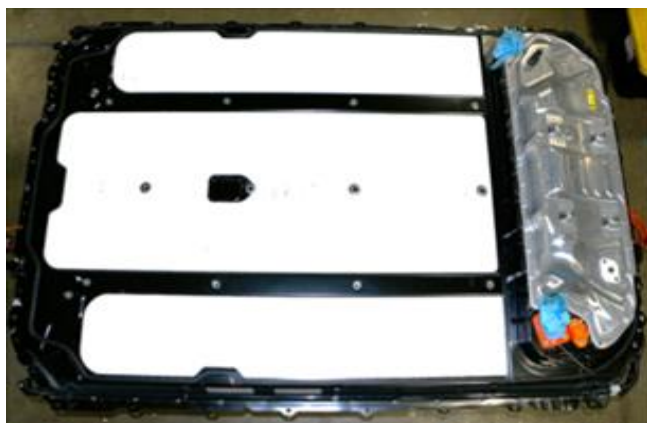
图 104：特斯拉电池包中的防火泡棉
