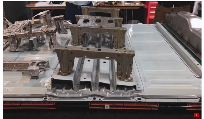
图 89：结构化电池包拆解图
