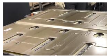
图 108：Rivian 电池阻燃设计——金云母
