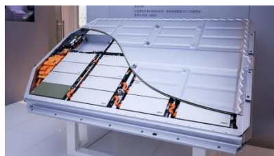
图 107：极狐阻燃设计——陶瓷纤维防火毯
