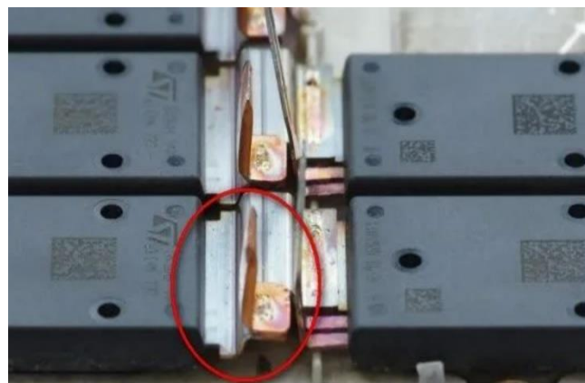
图 41: Model 3 SiC 模块输入母排
