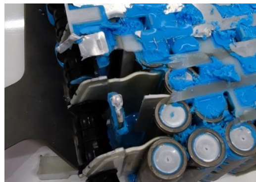
图 98：Model 3 上直线布置的液冷管实物图
