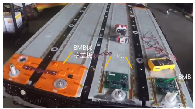
图 59: model 3 长续航版电池组及采样板
