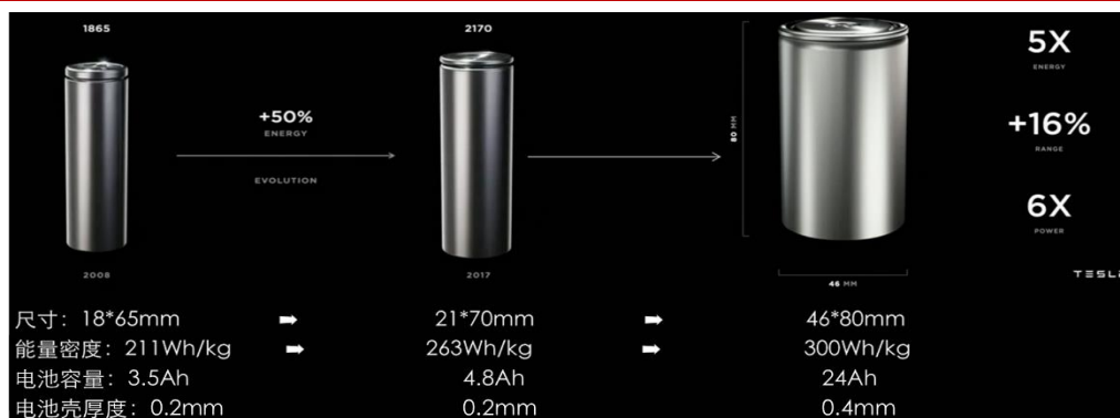
图 109：18650、2170、4680 电池尺寸及能量密度对比
