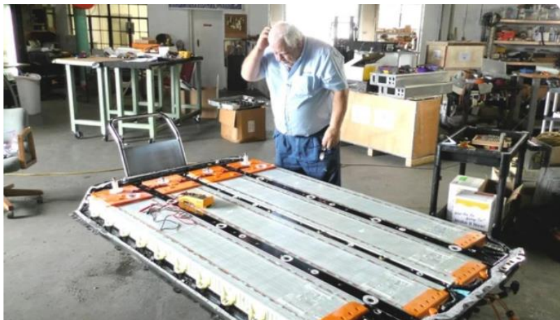
图 90：特斯拉 Model 3 底盘上电池包总体积为 188L，可分为 4 条小电池包
