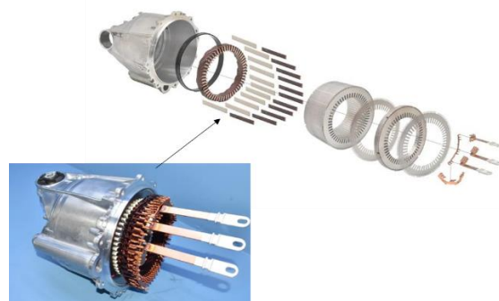
图 119：Model Y 十层油冷扁线电机
