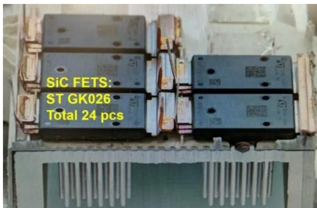
图 40: Model 3 SiC 模块 ST GK026（意法半导体）
