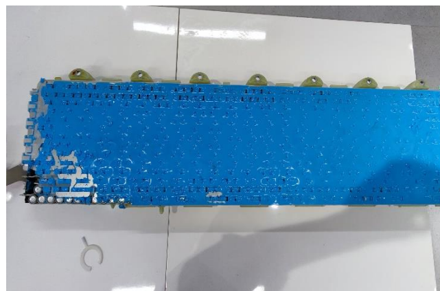
图 105：特斯拉电池包中采用的灌密封胶
