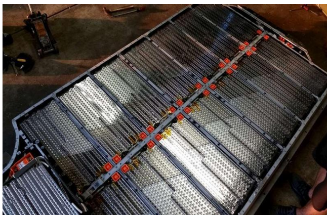
图 86: 旧款 Model S 上的小模组电池包
