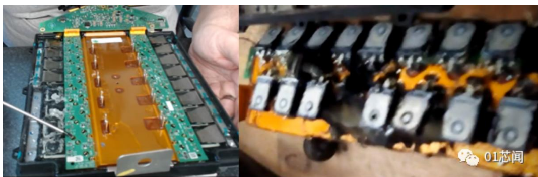
图 36：特斯拉 Model S 中 LDU 逆变器 IGBT 排布
