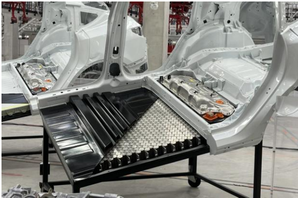
图 88：特斯拉展示的非模组结构化电池包方案
