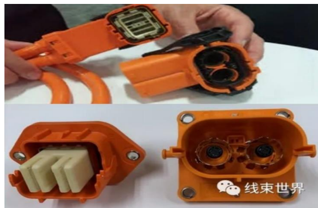
图 75: 插片式与圆柱式高压连接器尺寸对比
