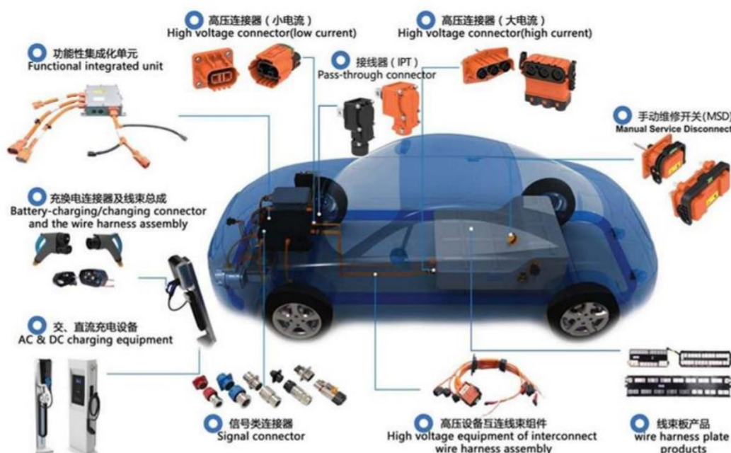
图 73：高压连接器在新能源整车系统中的应用
