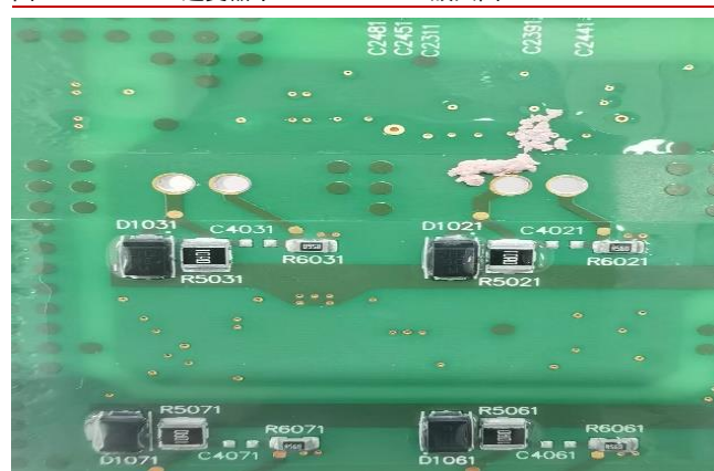
图 39：Model 3 逆变器中 SiC MOSFET 放大图
