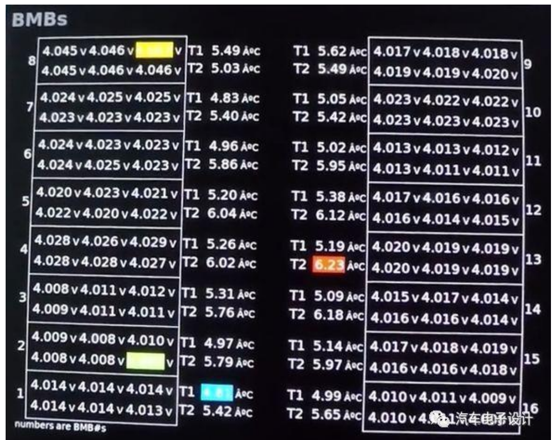
图 53：特斯拉 model S 诊断界面显示的电池组温度电压采样信息
