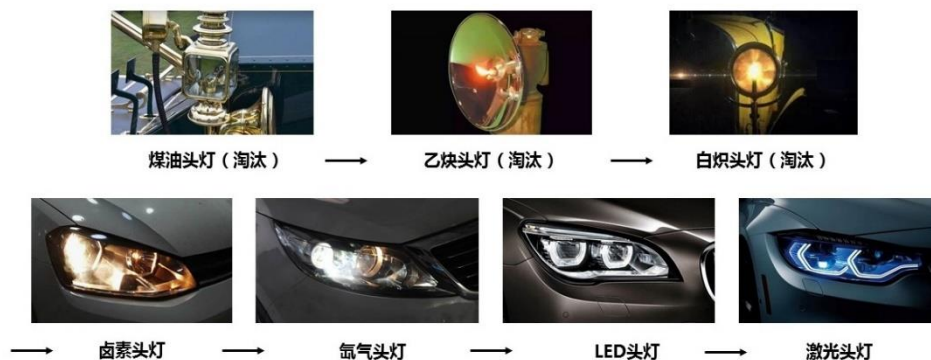
图 157：汽车头灯光源进化过程
