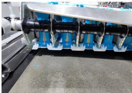
图 97：Model 3 上直线布置的液冷管流入段实物图
